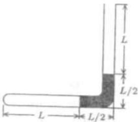
10. Имеется Г-образная тонкая трубка постоянного внутреннего сечения и общей длиной  $3L = 1260$  мм. Между слоем воздуха длиной  $L = 420$  мм и атмосферой находится слой ртути той же длины  $L$  (см. рис.). Какой длины слой ртути останется в трубке, если вертикальное колено повернуть на 180°, расположив его открытым концом вниз? Внешнее давление  $P_0 = 735$  мм рт. ст.
